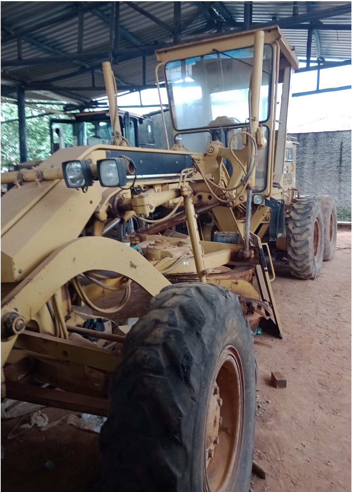
MAQUINA PESADA MOTONIVELADORA CATERPILLAR, Modelo 120H Ano / Modelo 1998, A MESMA SE ENCONTRA COM PROBLEMAS NA TRANSMISSAO QUE SE ENCONTRA DESMONTADA , PNEUS CONDENADOS, SEM BATERIAS
